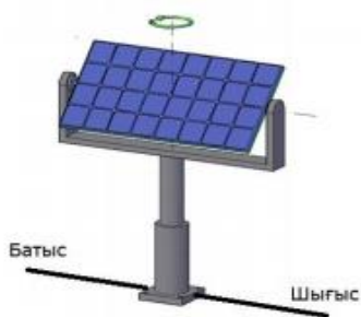
Сурет 1.4 – Бір осьті горизонтальды (азимут бойынша) бағытта қозғалатын бақылаушы жүйесі.
