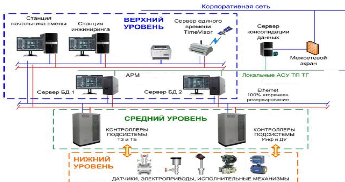
Рисунок 2. Диаграмма обмена данными при мониторинге процесса
