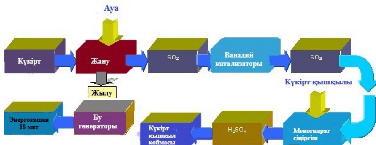
2-сурет. Күкірт қышқылын өндіру технологиясының блок-схемасы.
