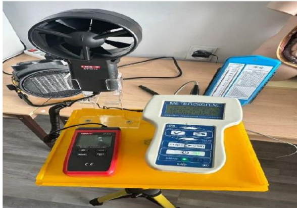
Сурет 1 - Ауа температурасы, ауа жылдамдығын өлшейтін метеостанция кешені
