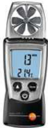
Сурет 3 - TESTO 410-1 TESTO 410-1 ауа ағынын және жылдамдығын өлшеуге арналған
