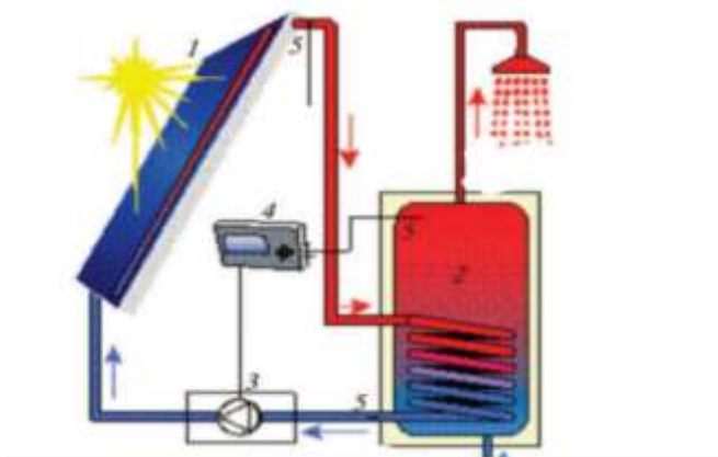
Сурет 4. Гелиожүйенің құрылымы 1 - вакуумдық коллектор; 2 - бак аккумулятор; 3 - сорғы; 4 - температура сенсоры.
