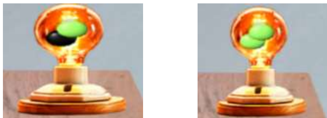
Рисунок 4 - Изменение яркости накала нитей пирометрической лампы и объекта измерения
