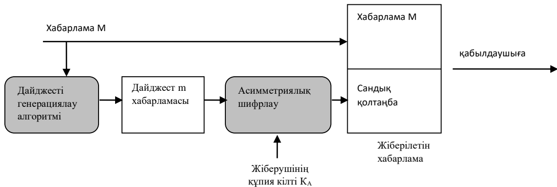
Сурет 1. Электронды сандық қолтаңбаны құру схемасы
