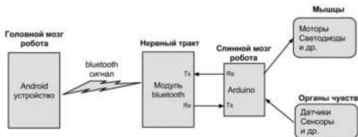
Сурет 1. Arduino nano базадағы роботтың жалпы схемасы.
