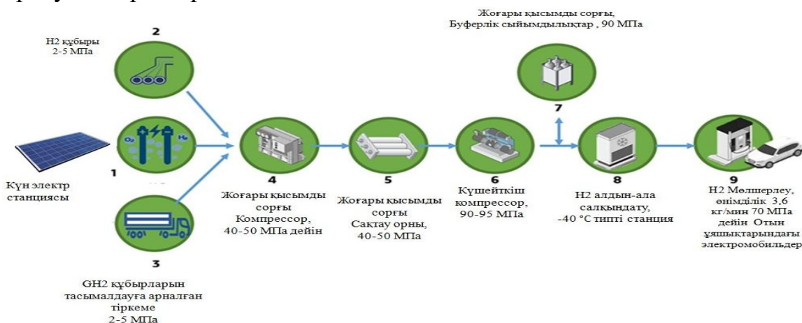
2 сұлба. Сутегі газын сақтау: компрессор бар сұлбасы.
