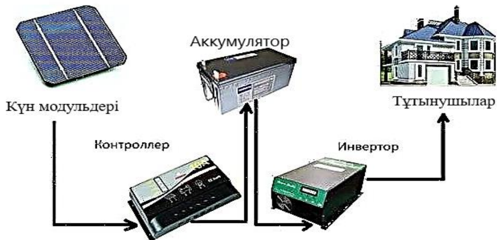
1-сурет. Күн сәулесімен жұмыс істейтін электрмен жабдықтау жүйесі
