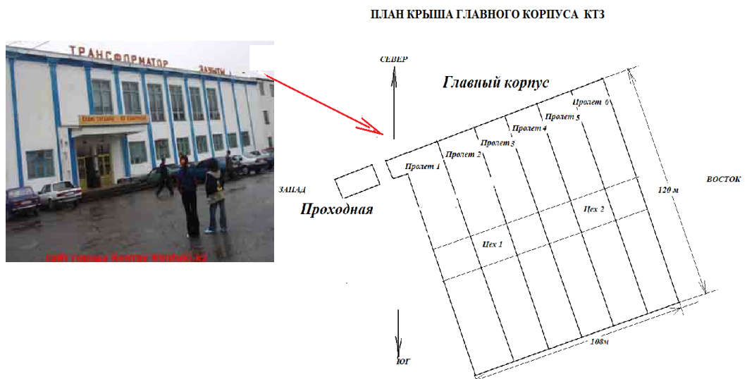
Сурет 1.3 Кентау трансформатор зауытының бас корпусының контуры, күн панелі орналастырылатын шатыр суреті мен жобасы.
