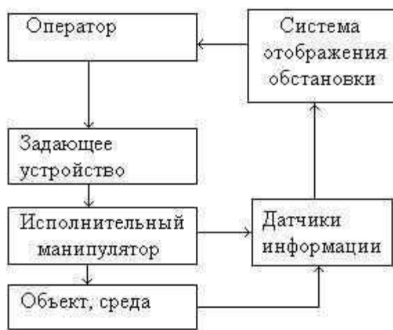
Рис.2 - Схема принципа следящей системы с соответствующим шарниром рабочего манипулятора
