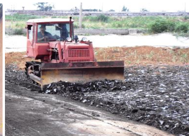
Выгрузка обезвоженного ОСВ Влажность менее 70%.
