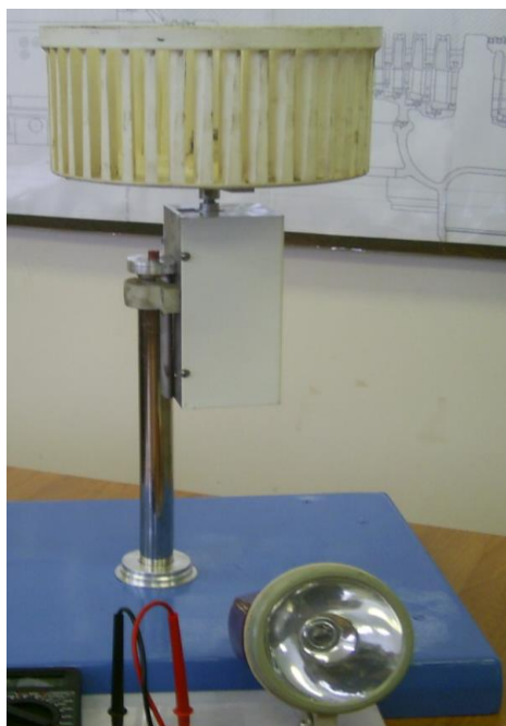
Рисунок 2 – Внешний вид ветрогенерирующей лабораторной установки с ветроколесом карусельного типа с вертикальной осью вращения
