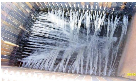
Выгрузка обезвоженного ОСВ Влажность менее 70%.
