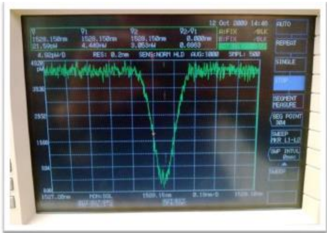
Рисунок 3. Спектральная характеристика света, проходящего через решетку при определенной температуре
