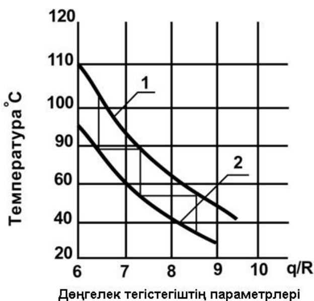
Сурет 4.21 - Күлдібитум мен АПШҚ негізіндегіасфальттыбетон төсеп басудың басталуы (1) және соңына дейінгі (2) температурасының тәуелділігі. q - желінің қысымы, \text{kH} / \text{м} ; R - роликті барабанның радиусы, \text{м} .
