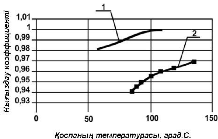
Сурет 4.20 - Ұсынылып отырған асфальттыбетон қоспасын нығыздау коэффициентінің нығыздаудың бастапқы температурасына тәуелділігінің графигі.
